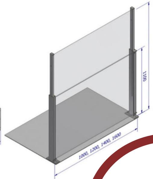
Geländer mit Aluminium-Blumentopf oder Stahlsockeln benötigen keine Befestigung auf dem Boden.
