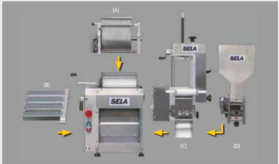
Die Ausrollwalze ist das Herz der MODULA. Sie produziert Teigblätter zur Weiterverarbeitung mit anderen Bestandteilen der Maschine oder zur Verwendung für die Herstellung von Lasagne.
