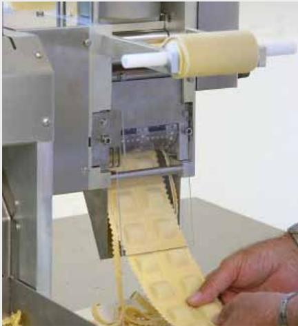
Die Raviolimaschine RV 30 verfügt über zwei Teigbänder á 100 mm und ermöglicht die Herstellung von bis zu 25 kg Ravioli pro Stunde.
