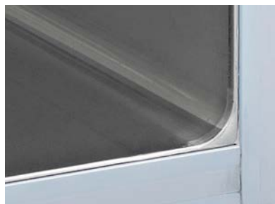
Detail zu Hygiene H2 nach DIN: Übergang von Boden zu Seitenwand mit Hygienradius R 17,5
